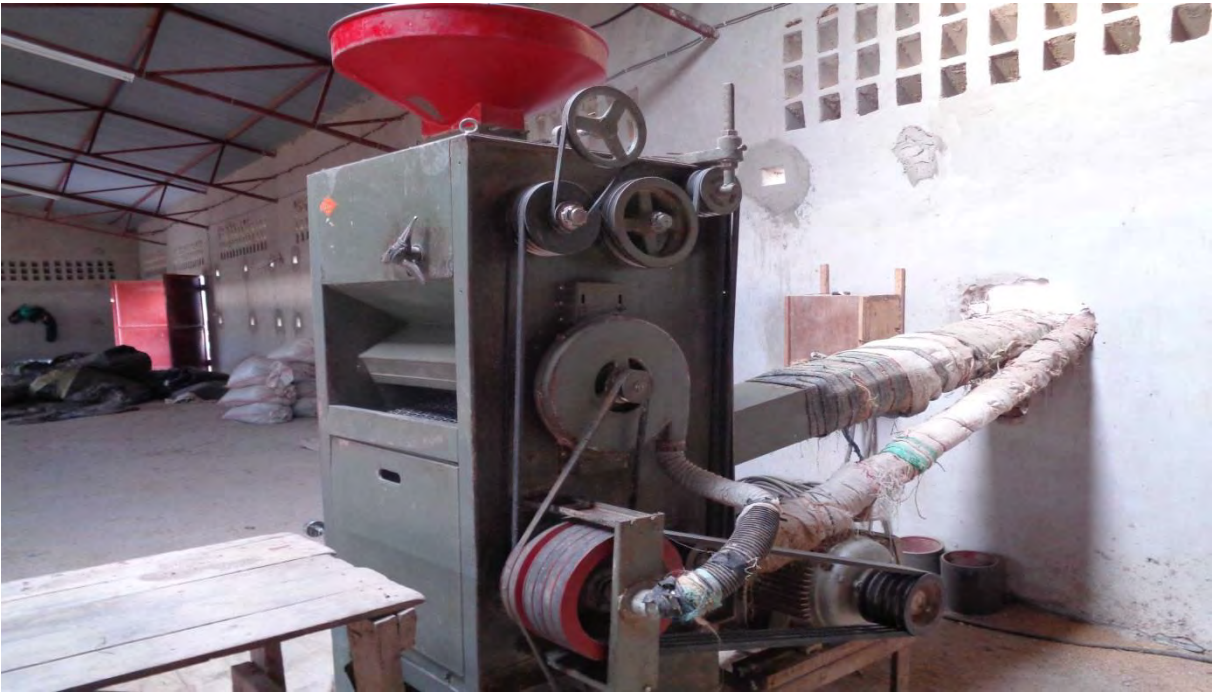
Rijstpelmachine met afvoerkanalen voor de rijst en voor de schilletjes
